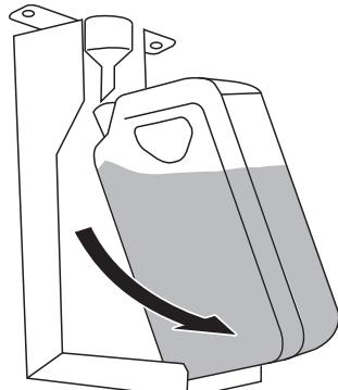
2. Setzen Sie die entleerte Auffangflasche schnell wieder in das Gerät.
